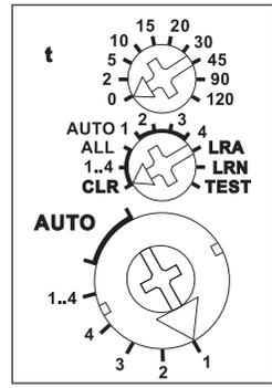
**Mit den Dreheschaltern** werden die Taster eingelernt und gegebenenfalls die 4 Kanäle getestet. Für den Normalbetrieb werden der mittlere und der untere Dreheschalter anschließend auf AUTO gestellt. Bei dem oberen Dreheschalter wird ggf. für alle Kanäle gleich die EW-Zeit (0-120 Sekunden) für Relais bzw. die RV-Zeit (0-120 Minuten) für Stromstoßschalter eingestellt.
