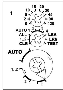
**Mit den Dreheschaltern** werden die Taster eingelernt und gegebenenfalls die 2 Kanäle getestet. Für den Normalbetrieb werden der mittlere und der untere Dreheschalter anschließend auf AUTO gestellt. Bei dem oberen Dreheschalter wird ggf. für alle Kanäle gleich die EW-Zeit (0-120 Sekunden) für Relais bzw. die RV-Zeit (0-120 Minuten) für Stromstoßschalter eingestellt.
