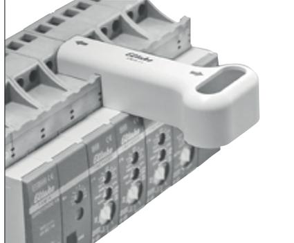
**Zum Aufstecken und Abziehen der Steckbrücken nur das Steckbrücken-Montagewerkzeug SMW14 benutzen und senkrecht zur Tragschiene bewegen.**
