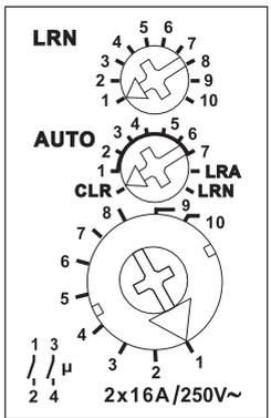
**Der mittlere Drehschalter** wird in der Position LRN für das Einlernen benötigt. Im Betrieb wird hier die gewünschte Betriebsart eingestellt.
