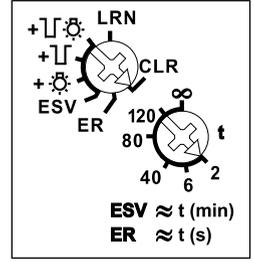
**Mit dem oberen Drehschalter** werden in der Stellung LRN bis zu 35 Funktaster zugeordnet, davon ein oder mehrere Zentralsteuerungs-Taster. Außerdem Funk-Fenster-Türkontakte mit der Funktion Schließer oder Öffner bei geöffnetem Fenster, Funk-Helligkeitssensoren und Funk-Bewegungsmelder.
