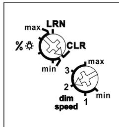
Mit dem oberen %-Dreheschalter kann die Mindesthelligkeit (voll abgedimmt) eingestellt werden. In der Stellung LRN werden bis zu 35 Funktaster zugeordnet, davon ein oder mehrere Zentralsteuerungs-Taster.
