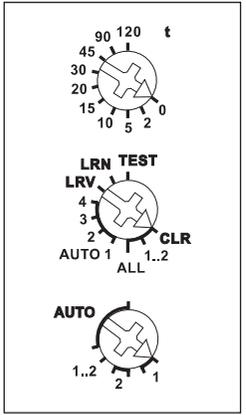
**Mit den Drehschaltern** werden die Taster eingelernt und gegebenenfalls die 2 Kanäle getestet. Für den Normalbetrieb werden der mittlere und der untere Drehschalter anschließend auf AUTO gestellt. Bei dem oberen Drehschalter wird ggf. für alle Kanäle gleich die EW-Zeit (0-120 Sekunden) für Relais bzw. die RV-Zeit (0-120 Minuten) für Stromstoßschalter eingestellt.
