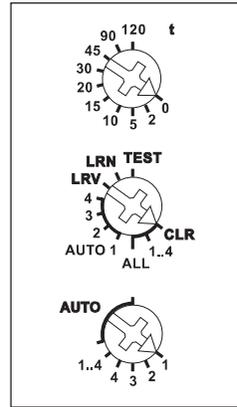
**Mit den Drehschaltern** werden die Taster eingelernt und gegebenenfalls die 4 Kanäle getestet. Für den Normalbetrieb werden der mittlere und der untere Drehschalter anschließend auf AUTO gestellt. Bei dem oberen Drehschalter wird ggf. für alle Kanäle gleich die EW-Zeit (0-120 Sekunden) für Relais bzw. die RV-Zeit (0-120 Minuten) für Stromstoßschalter eingestellt.
