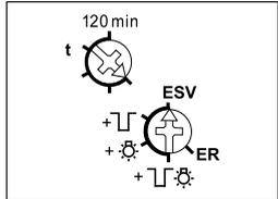
**Bei zugeschalteter Ausschaltvorwarnung flackert** die Beleuchtung ca. 30 Sekunden vor Zeitablauf beginnend und insgesamt 3-mal in kürzer werdenden Zeitabständen.
