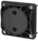
FA 150 VBF-K ist ein Vorbaufansch aus verstärktem Kunststoff zum Andübeln über Kernbohrungen und Durchbrüchen bis 150 mm. Der Vorteil liegt im systemseitigen Anschluss von FA 150 Dichteinsätzen zur gas- und druckwasserdichten Gebäudeeinführung von Kabuflex Rohren, Stromkabeln und Elektroinstallationsrohren ab Druckfestigkeit 3.
