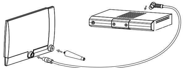
2. Den Receiver mit dem TV-Gerät verbinden. Nähere Informationen zum Anschluss der Anleitung des jeweiligen Receivers entnehmen.
