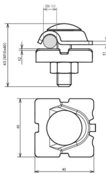
Die Arretiernase dient der sicheren Verriegelung der MV-Klemme bei Kreuzanordnung.
