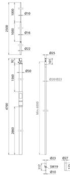
Mit innenliegendem Endverschluss und Fangstange Ø22 /16 / 10 mm.
