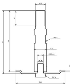
Fußstück mit Flanschplatte für Tiefenerder schraubbar zur Vermeidung des Einsinkens in das Erdreich.
