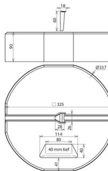
Betonsockel für Fangstangen, zum Schutz von kleineren Dachaufbauten auf Flachdächern und für das Errichten von Distanzhaltern z. B. für getrennte Ringleitungen oder freistehende Fangstangen im Dreibeinestativ.
