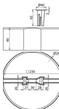
Betonsockel mit Gewintheadapter für Fangstangen Ø16 mm mit Gewinde M16, zum Schutz von kleineren Dachaufbauten auf Flachdächern und zusätzlicher Befestigung z. B. mit DEHNiso-Distanzhalter.
