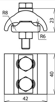
mit Gewinde im Unterteil und Kontermutter M8
