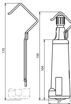
Das Werkzeug kann zum Abmanteln des zusätzlichen grauen Mantels der HVI light Leitung und HVI Leitung verwendet werden. DEHNhelix besteht aus einem Handgriff und zusätzlich wechselbarem Bügel (je nach Durchmesser der Leitung).
