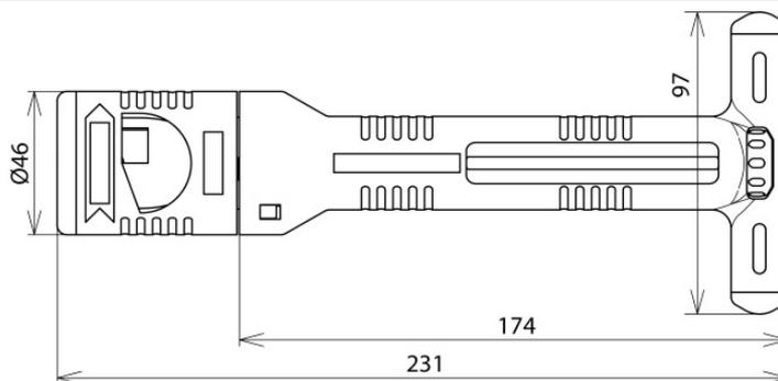
HVI strip 20 Werkzeug zum Absetzen des halbleitenden Mantels und gleichzeitig der PE-Isolierung der HVI Leitung, HVI light plus Leitung und HVI light Leitung mit einem Außendurchmesser von 20 mm. Die Abisolierlänge ist in Stufen (Rastpunkte) von 0,2 mm über das im Griff eingebaute Stellrad regulierbar. Ausführung komplett mit Handgriff und Schneidkopf.
