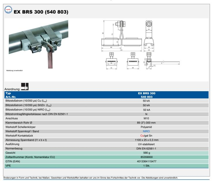
In Bezug auf die Korrosionsbeständigkeit sind die verwendeten Materialien bei den Ex-BandRohrSchellen, Ex-BRS ... (z. B. Cu/galSn, Ms/galSn, NIRO, Polyamid) bezüglich deren Anwendbarkeit in der vorhandenen Umgebungsbedingung zu prüfen.
