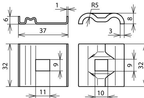
Erdungsklemmen zum Einbinden der Montagesysteme z. B. von PV-Anlagen in den Funktionspotentialausgleich/Funktionserdung (Leiterfarbe ggf. schwarz) und Blitzschutz-Potentialausgleich nach DIN EN 62305-3 (VDE 0185-305-3)
