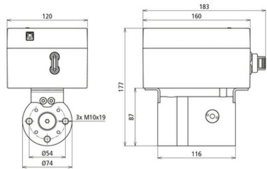
Löschgerät für den direkten Anschluss an die Erfassungsgeräte DSRT DD CPS und DSRT DD PS.
