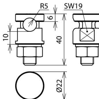
Klemmschrauben-Verbinder mit Federring sowie zusätzlich angebrachter Haltefläche zum Anschluss von Rundleitern an Flachprofile. Blitzstromtragfähigkeit geprüft bis 200 kA (10/350 µs).
