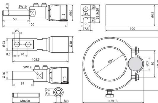
Anschlussset für HVI power Leitung zur Verlegung an HVI power Stützrohren GFK / Al bestehend aus Anschlusselemente, Gewindestifte, Anschlusssteil, Schrumpfschlauch, Kabelbinder und Befestigungsring mit einem geschlitzten Leitungshalter (Ø27 mm).
