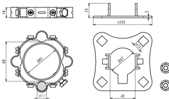
Befestigungsset zur Montage der HVI light Leitung am Stützrohr  $\varnothing 50$  mm, bestehend aus Anschlussplatte (vierfach, inkl. zwei Sperrzahnmuttern) und Befestigungsring mit vier geschlitzten Leitungshaltern ( $\varnothing 20$  mm) für den Anpassungsbereich (inkl. zwei Kabelbinder).
