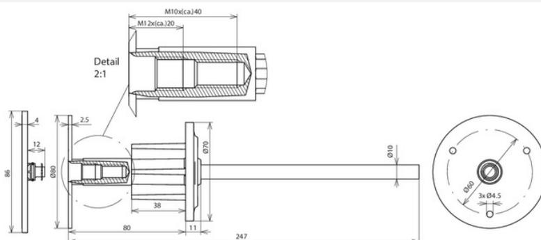
Gegen das weitere Eindringen von Wasser entlang der Achse in die Wand (geprüft mit Druckluft 5 bar nach DIN EN 62561-5 und mit 1 bar Druckwasser). Für WU-Beton (wasserundurchlässiger Beton) geeignet.
