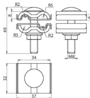
Verbindungsklemme zum Verbinden von Gittermatten bzw. zum Anschließen von Gittermatten an Erdungssystemen.
