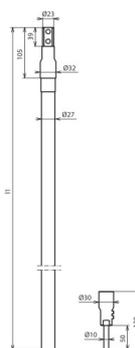
Hochspannungsfeste isolierte Ableitung zum Einhalten des Trennungsabstandes zu elektrisch leitenden Teilen nach DIN EN 62305-3 (VDE 0185-305-3).
