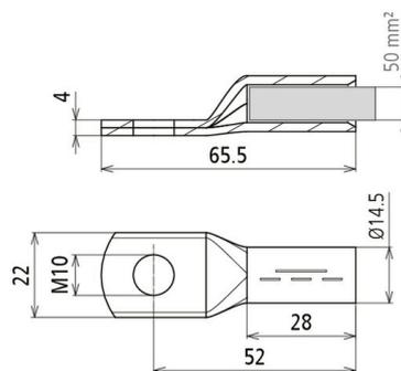
Presskabelschuh nach DIN 46235 mit Nickelspersschicht zur Vermeidung von Whiskerbildung.
