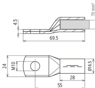
Presskabelschuh nach DIN 46235 mit Nickelsperschicht zur Vermeidung von Whiskerbildung.
