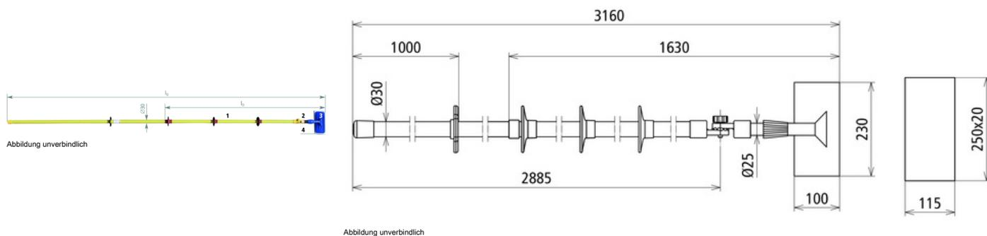
Isolierstangenset zum Reinigen der Sichtscheiben von E-Loks
