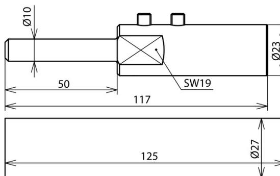
Anschlusselement zum Abschließen der HVI long Leitung, beim Erstellen des Endverschlusses der Leitung für andere Teile des Äußeren Blitzschutzes oder der Erdungsanlage (inkl. ein Schrumpfschlauch).
