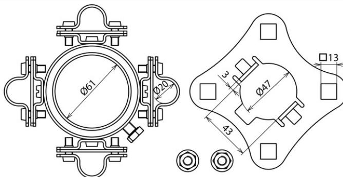
Befestigungsset zur Montage der HVI long Leitung an HVI long Stützrohren, bestehend aus Anschlussplatte (vierfach, inkl. zwei Sperrzahnmuttern) und Befestigungsring mit vier geschlitzten Leitungshaltern (Ø20 mm) für den Endverschluss (inkl. zwei Kabelbinder mit Kunststoffhalterhalbteilen).
