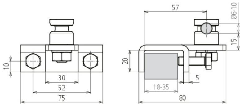
Schwere Ausführung; für den Anschluss an Stahlkonstruktionen.
