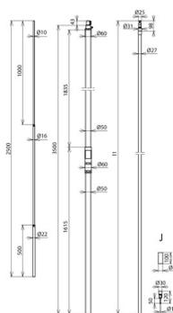
Stützrohr mit innenliegendem Endverschluss und PA-Federelement. Fangstange Ø22 / 16 / 10 mm.
