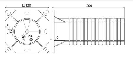
Ausfuhrung mit Styroporkern (keine Wärmebrücke) zum Kombinieren mit dem Trennstellenkasten. Der Abstandshalter kann in 10 mm Abstufungen von 200 - 50 mm gekürzt werden.
