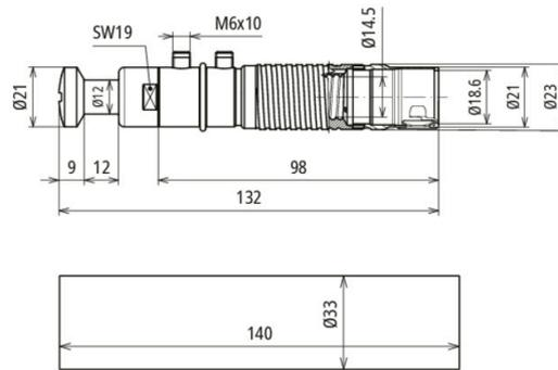
Ein isolierendes Anschlusselement zum Abschließen der HVI light plus Leitung bei Rohrrinnenverlegung. Durch die Verwendung von isolierenden Anschlusselementen kann an der HVI light plus Leitung eine Isolationsprüfung durchgeführt werden. Dieses isolierende Anschlusselement kann für die Rohrrinnenverlegung in Stützrohren Ø40 mm und Ø50 mm verwendet werden.
