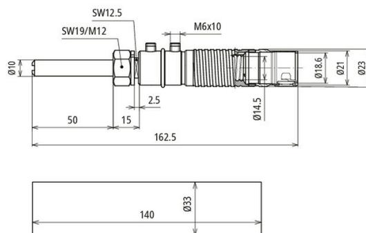
Ein Anschlüsselement zum Abschließen der HVI light plus Leitung, zum Erstellen des Endverschlusses der Leitung am Stützrohr (Kopfstück) oder zum Anschließen an andere Teile des äußeren Blitzschutzes (inkl. einem Schrumpfschlauch).
