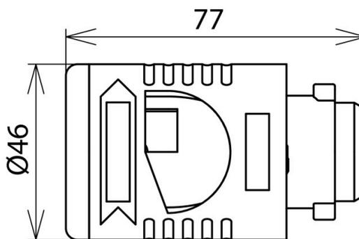
Das Anbringen des austauschbaren Schneidkopfes an den Handgriff erfolgt werkzeuglos über eine Bajonettkupplung.
