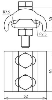
Klemmen mit Federring zum Verbinden/Anschließen von Rundleitern/Seile in explosionsgefährdeten Bereichen Zone 1/21, 2/22. Die Klemmen sind entsprechend DIN EN 62305-3 Beiblatt 2 (VDE 0185-305-3 Bbl 2) gegen Selbstlockern gesichert.
