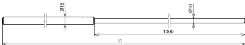
Fangstange mit Verjüngung (1000 mm) angefast, zum Schutz von Dachaufbauten, Kaminen usw., speziell für Betonsockel (17 kg) mit Keiltechnik oder für die Befestigung mit Stangenhaltern / Distanzhaltern.
