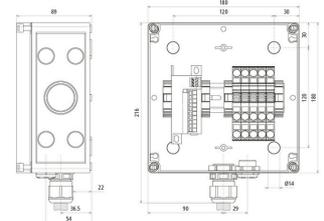
Gehäuseanschlusskasten für E-Mobility.
