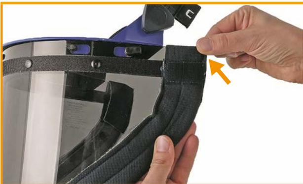
Das gegenüberliegende taschenförmige Ende des Haubenteils an der entgegengesetzten Ecke des Schutzschirmes einhängen.
