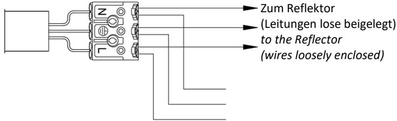
Durchgangsverdrahtung 5 polig
