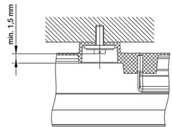
Montage mit Halteklammern / Fixing with Clamps
