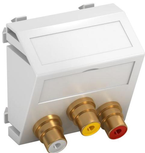
Multimediaträger mit drei Cinch Anschlussbuchsen für Audio-Video, Kabelausschlass schräg, mit Beschriftungsfeld, drei Cinch Buchsen (RCA) mit Lötanschluss, Farbkodierung gelb/rot/weiß. Trägerplatte mit Rastbefestigung, geeignet für den waagerechten und senkrechten Einbau in die Systemumgebung.
