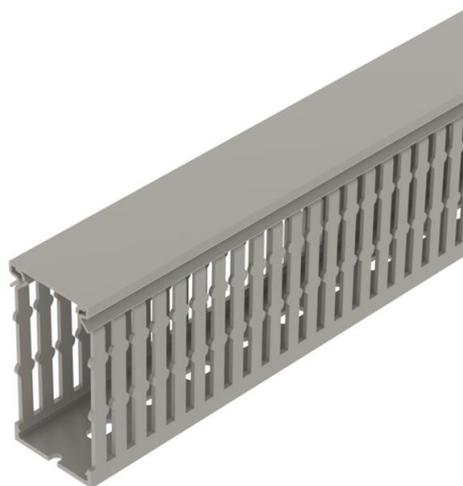
Verdrahtungskanal inkl. Oberteil und Bodenlochung zur waagerechten und senkrechten Verlegung elektrischer Kabel und Leitungen im Schaltschrank. Das Ausbrechen der Stege erfolgt werkzeuglos. Sonderlängen auf Anfrage. Geprüft nach DIN EN 50085-2-3. Unter- und Oberteil im Set.
