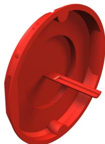
Signaldeckel schützen das Innere, die Schraubdomme und Schraubenköpfe beim Verputzen. Die Markierungsborsten ermöglichen das einfache Wiederauffinden der Dosen und Kästen nach dem Verputzen. Die Signaldeckel können mehrfach benutzt werden. Deckel nach dem Verputzen einfach in die Dose drücken und Signaldeckel entfernen.
