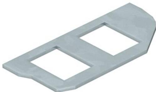
Montageplatte zur Aufnahme von zwei Daten-Anschlussmodulen folgender Typen: AMP TYCO: Standard 110Connect, SL Serie 110Connect u. Toolless, AMP-Twist; Brand-Rex: ungeschirmt; GG45; TKM RJ MOD; Nexans: LANmark mit Adapter-Clip; Siemon CAT6; 3M K6 und K10. Abmessung einer Montageöffnung in mm: 20,10 x 14,80.
