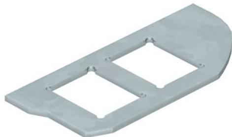
Montageplatte zur Aufnahme von zwei Daten-Anschlussmodulen folgender Typen: Brand-Rex: geschirmt; EKU: E-Stone; Dätwyler: KS-T, MS-K und KU-T; R&M: Snap-In und Keystone; Rutenbeck: UM und UMflex; SETEC: MKJ, UKJ und XKJ; Siemon TERA; Telegärtner: AMJ und UMJ. Abmessung einer Montageöffnung in mm: 19,30 x 14,80.
