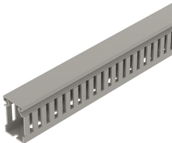
Verdrahtungskanal inkl. Oberteil und Bodenlochung zur waagerechten und senkrechten Verlegung elektrischer Kabel und Leitungen im Schaltschrank. Das Ausbrechen der Stege erfolgt werkzeuglos. Sonderlängen auf Anfrage. Geprüft nach DIN EN 50085-2-3. Unter- und Oberteil im Set.
